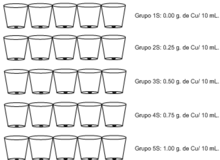
Imagen 4: Representación del montaje general de las muestras del cultivo en suelo y la cantidad de cobre añadida por 10 mL. (Por riego en días alternos)
