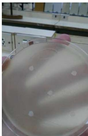
Ilustración 6: Placa sin halos de inhibición. Prueba negativa
